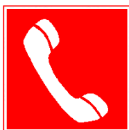
телефон для использования при пожаре (в том числе телефон прямой связи с пожарной охраной)
